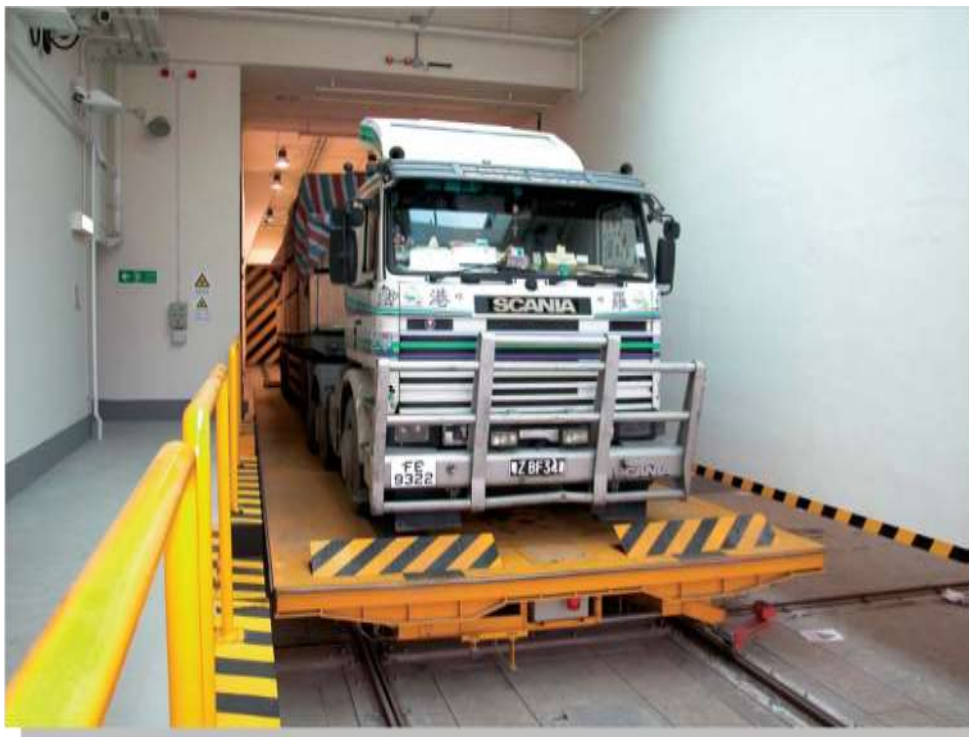
Scanographie à rayons X d'un camion porte-conteneurs par le système d'inspection de véhicule à rayons X fixe du poste de contrôle de la frontière terrestre de Lok Ma Chau, à Hong Kong
