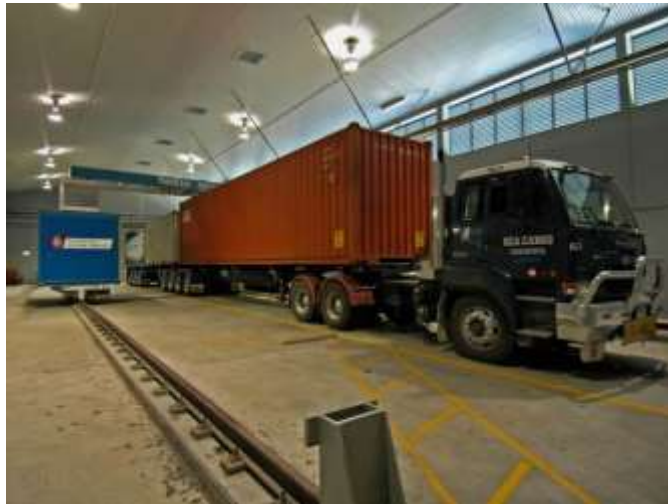
Dispositif Nuctech MB1215 à rayons X pour conteneurs
