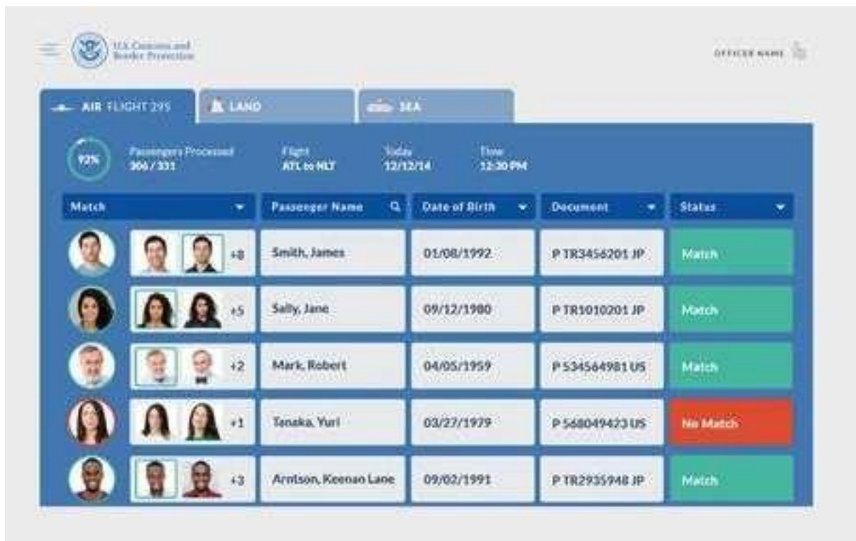
Figura 1. El servicio de comparación biométrica de CBP utiliza datos de manifiesto del sistema de información de pasajeros avanzado (APIS) biográfico y fotografías existentes (encuentros anteriores de CBP, pasaporte de EE. UU., Visa de EE. UU.) Para construir una galería de vuelos. Luego, el servicio de correspondencia biométrica compara la "fotografía en vivo" tomada antes del embarque con imágenes de la galería asociada con el manifiesto para crear una salida confirmada.
